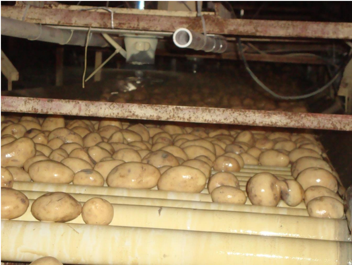
Figura 2. Sistema de aplicación de fungicidas en rodillos para el control de la roña común de la papa en tubérculos-semilla previo a su almacenamiento en bodegas refrigeradas.
