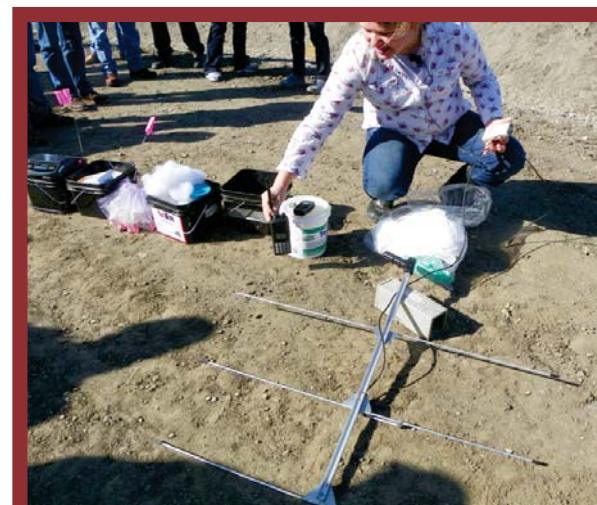
Muestra de equipo de radiotelegrafía para localización de roedores y conocer su ubicación.
